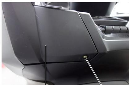
Coperchio batteria    Vite coperchio batteria
