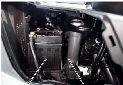
Batteria    Vano batteria
