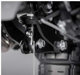
Regolazione idraulica in estensione
