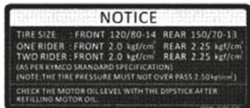
LA PRESSIONE DEI PNEUMATICI NON DEVE SUPERARE I 2,5 KG/CM<sup>2</sup> (2,5 BAR; 2,5 ATM) DOPO AVER RABBOCCATO L'OLIO MOTORE CONTROLLARNE IL LIVELLO UTILIZZANDO L'APPOSITA ASTINA.
