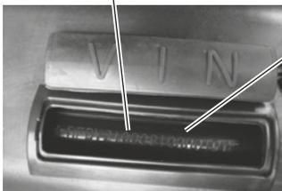
Il numero di telaio è punzonato sulla traversa del telaio, all'interno del vano sottosella. Per accedervi è necessario sollevare la sella e aprire il coperchio con la scritta "VIN".
