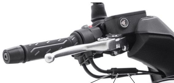
Controddado (3) Vite di regolazione (2) Manicotto in gomma (1)
